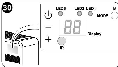
Activation/désactivation (Stand-by) de la climatisation et sélection de la vitesse de ventilation.
