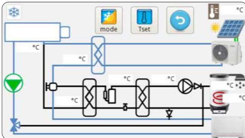
Le synoptique représente le schéma du système et montre l'état de fonctionnement en temps réel.
