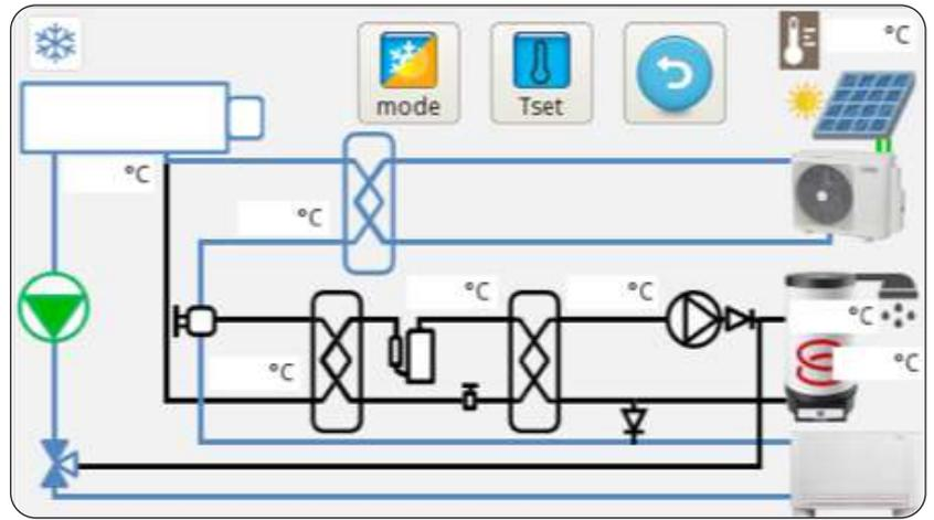
El sinóptico representa el esquema de sistema y muestra el estado de funcionamiento en tiempo real.
