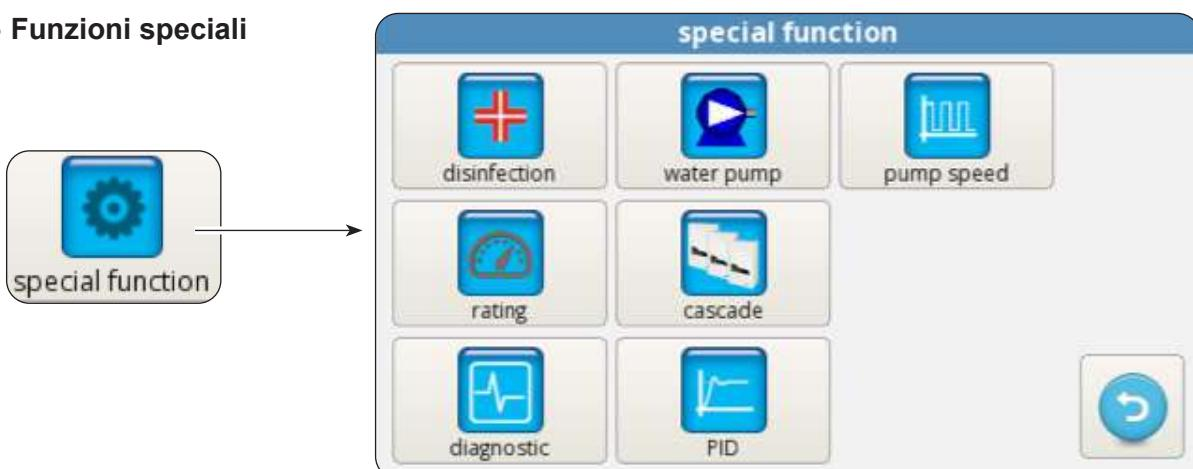
La schermata funzioni speciali comprende una serie di funzioni e comandi per la configurazione ed il monitoraggio della pompa di calore.
