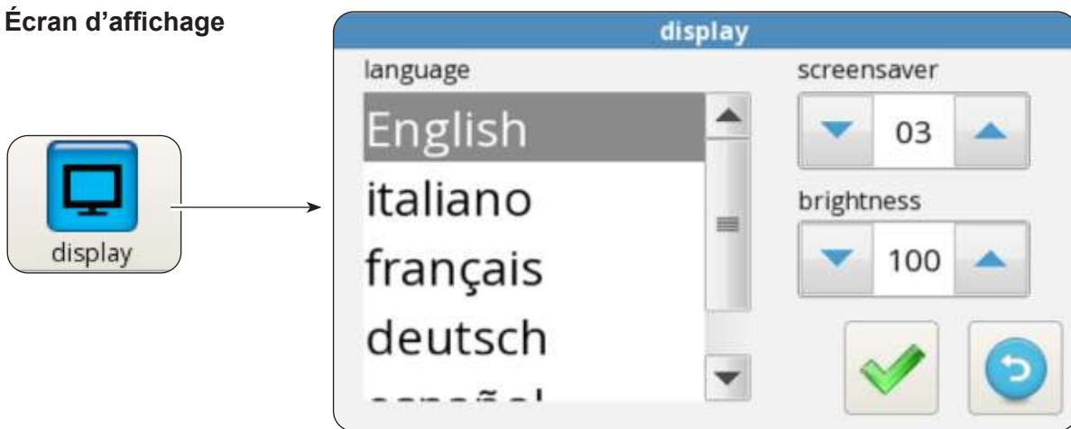
La page-écran permet de sélectionner la langue, de régler le délai de démarrage de la fonction d'économiseur d'écran et de régler la luminosité de l'écran.
