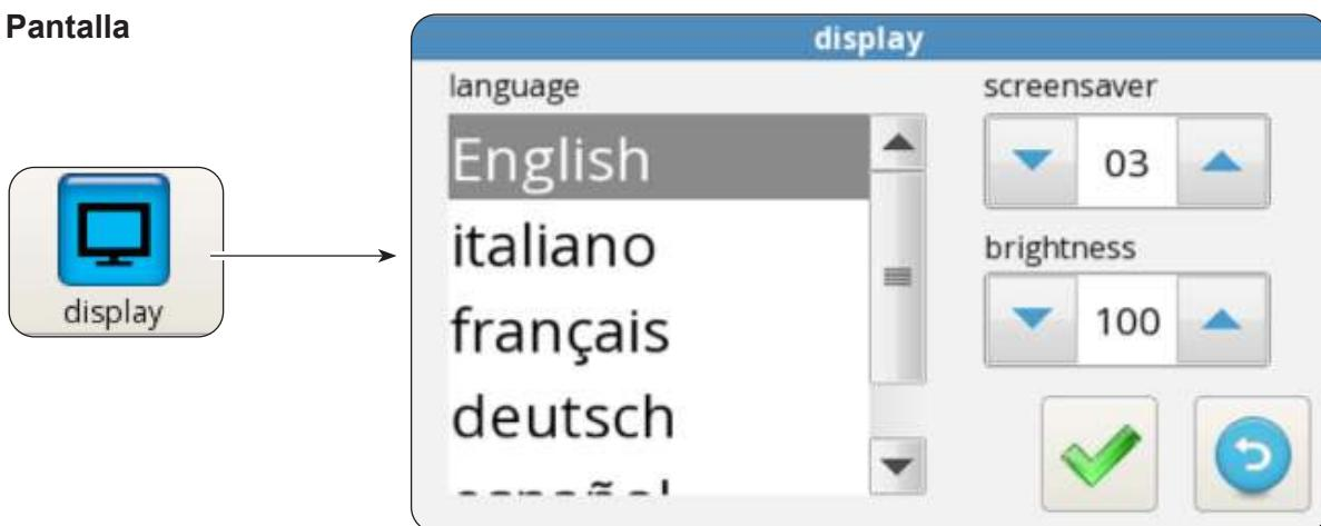
La pantalla permite seleccionar el idioma, configurar el tiempo de retraso del inicio de la función de protección de pantalla y configurar la luminosidad de la pantalla.
