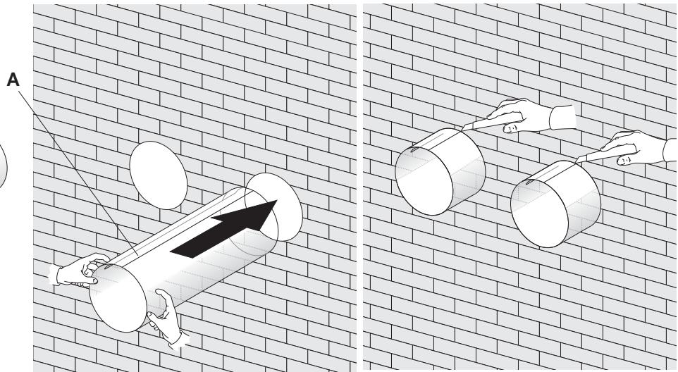
**Montaje de los conductos de aire y de las rejillas exteriores**
