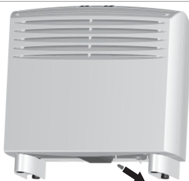
**Evacuación del agua de condensación en caso de emergencia**
