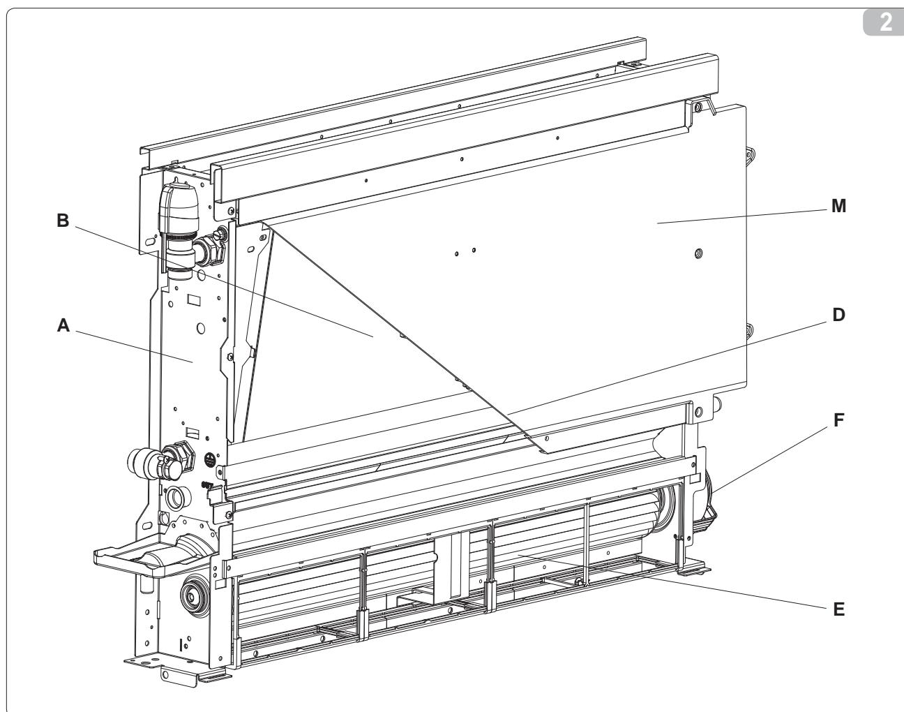
**D - Pannello radiante** ad elevata efficienza collegata alla batteria ad acqua calda (versione SLR). Per le versioni a due tubi il gruppo idraulico è dotato di una valvola calostat che impedisce l'ingresso dell'acqua fredda al pannello.
