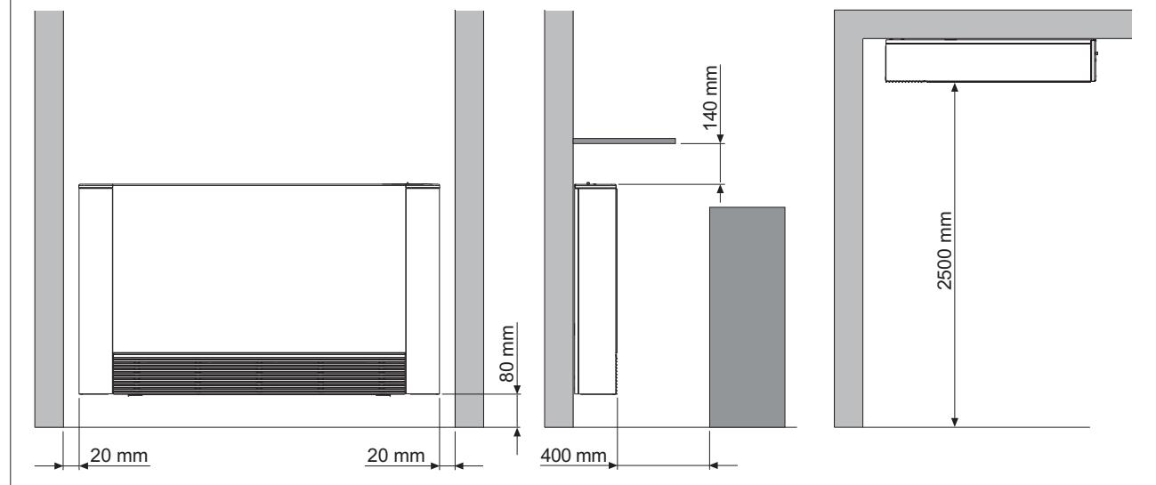
El aparato debe ser instalado en una posición que permita realizar fácilmente las operaciones de mantenimiento ordinario (limpieza del filtro) y extraordinario, así como el acceso a las válvulas de purga de aire (batería y placas), que pueden ser alcanzadas a través de la rejilla superior (en el lado de las conexiones).
